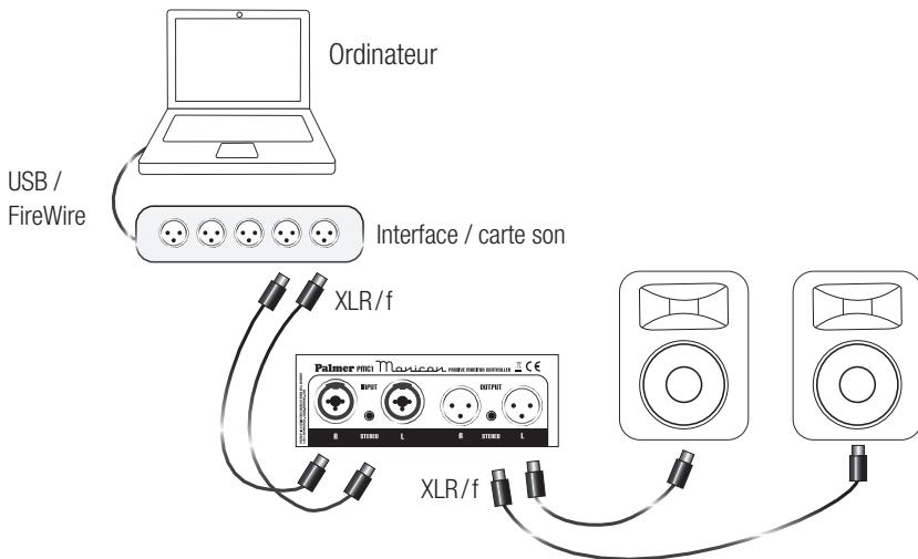
Si vous utilisez une interface audio munie de connecteurs de sortie de type XLR ou jack 6,35 mm, le Monicon permet de travailler en symétrique. Utilisez alors un câble de patch ou microphone, avec blindage de haute qualité.
