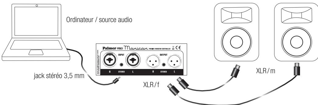
Si vous désirez utiliser la sortie casque de l'ordinateur, il vous faut un cordon mini-jack 3,5 mm stéréo vers mini-jack 3,5 mm stéréo. Introduisez l'un des connecteurs dans la sortie casque de l'ordinateur et l'autre dans l'entrée mini-jack du Monicon.
