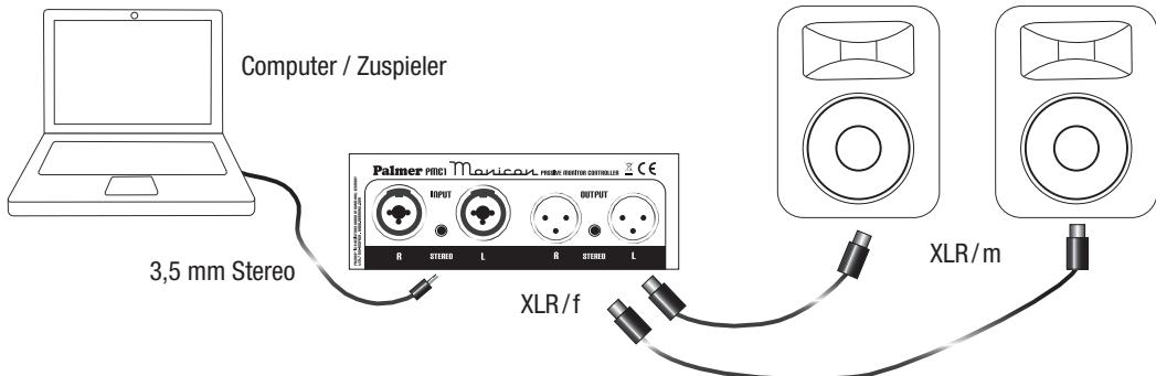
Wenn sie den üblichen Kopfhörerausgang verwenden möchten, benötigen Sie ein 3,5mm Stereokabel Miniklinke – Miniklinke. Schließen Sie ein Ende an den Kopfhörerausgang und das andere an den 3,5mm Klinkeneingang des Monicon an.
