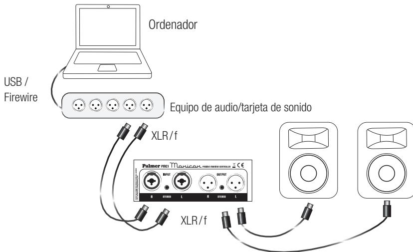
Si tiene un equipo de audio con salidas XLR o de jacks de 6,3 mm, podrá emplear un cable balanceado. Utilice un latiguillo de cable blindado o de micrófono de alta calidad.
