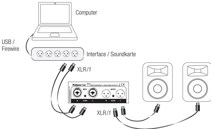
Wenn Sie über ein Interface mit XLR- oder 6,3mm Klinkenausgängen verfügen, ist auch eine symmetrische Leitungsführung möglich. Verwenden Sie dazu hochwertige abgeschirmte Patch- oder Mikrofonkabel.
