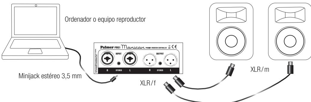
Si desea usar la salida habitual de auriculares, necesitará un cable con minijack estéreo de 3,5 mm en los dos extremos. Conecte un extremo a la salida de auriculares y el otro a la entrada minijack de 3,5 mm del Monicon.
